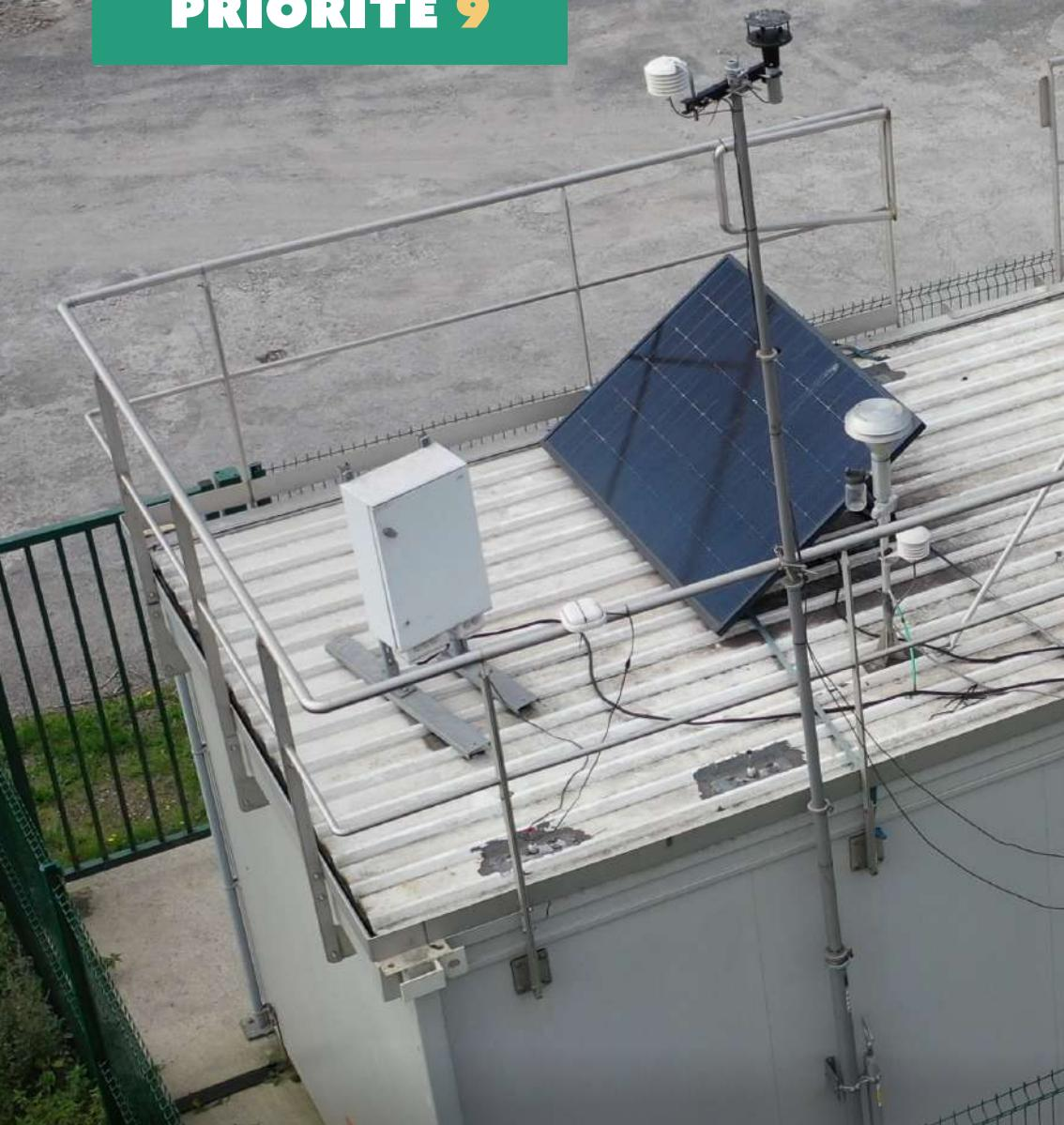
*Station de mesure, parmi les 48 réparties sur le territoire, de l'observatoire de la qualité de l'air en Hauts-de-France pilotée par l'ATMO Hauts-de-France, située à Grande-Synthe (59). Ces stations permettent de surveiller en temps réel l'air que nous respirons, d'informer au quotidien et alerter en cas de pollution atmosphérique.*
